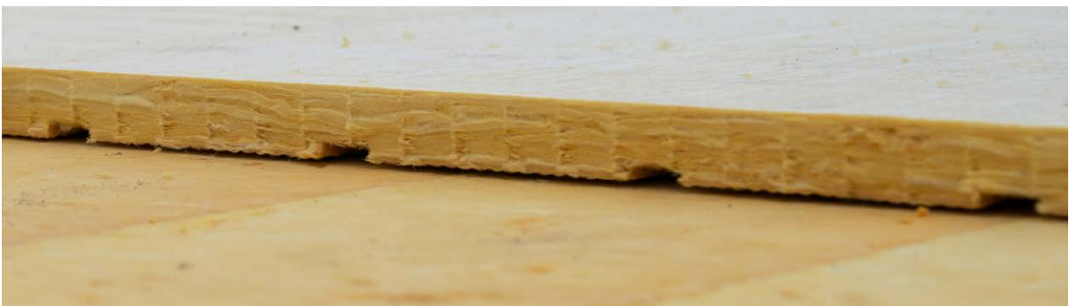
Eristeiden tuuletusurat yhdistetään kokoojakanavistoon sekä alipainetuulettimiin.
